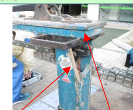
立筒部が破損してかさ板部の左部が傾斜し、零調整ができない
