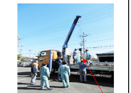
大型はかりの検査-2 * 1tの吊りばかり
